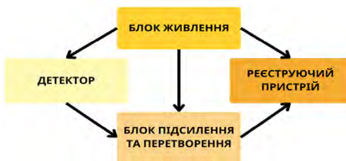
Рис. 11.4. Принцип будови дозиметричних приладів
